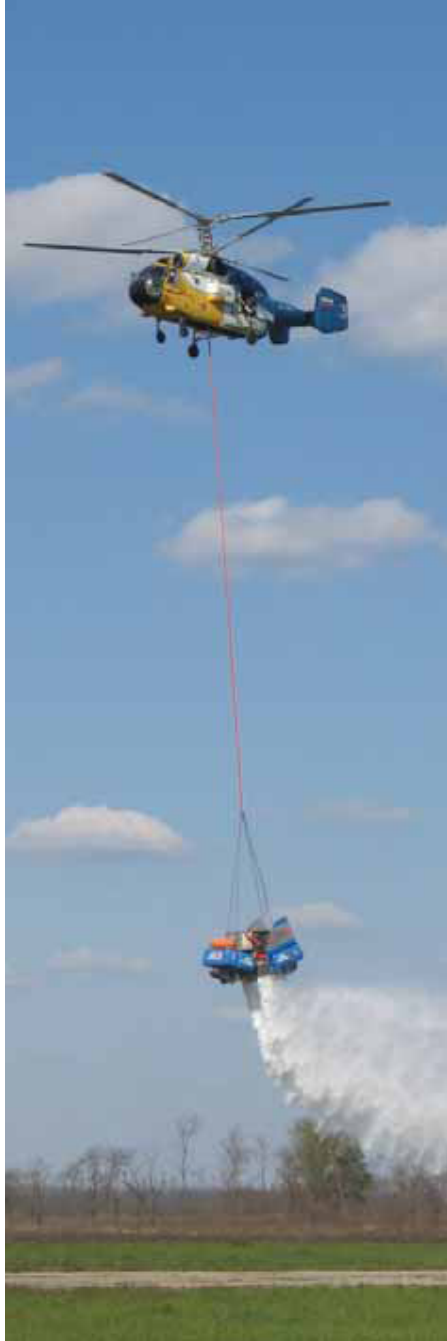
Создание заградительной пенной полосы шириной 6–8 м и длиной 400–600 м
