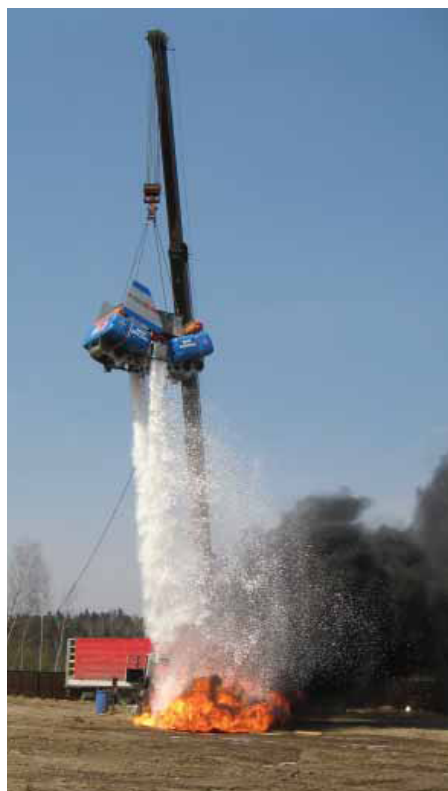
Стендовые огневые испытания вертолетного водосливного устройства УКТП «Пурга»
